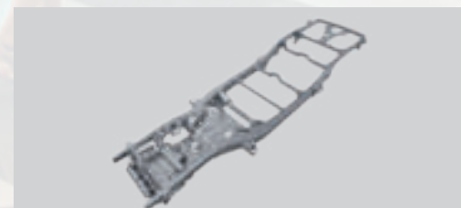
KHUNG GẮM CỨNG CẤP: Được bổ sung thêm dầm ngang giúp tăng khả năng bảo vệ đối khi xảy ra va chạm
